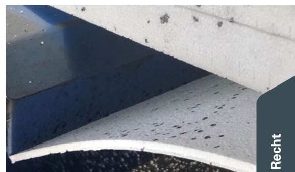
▶ Vertikaler Schnitt: Der Block wird besäumt und auf Breite geschnitten, Abschnitt mit Produktionshaut wird zur Wiederverwertung zerkleinert.
