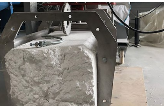
▲ Zu Briketts kompaktierte EPS-Reste für die Weiterverarbeitung im Extrusionsverfahren
