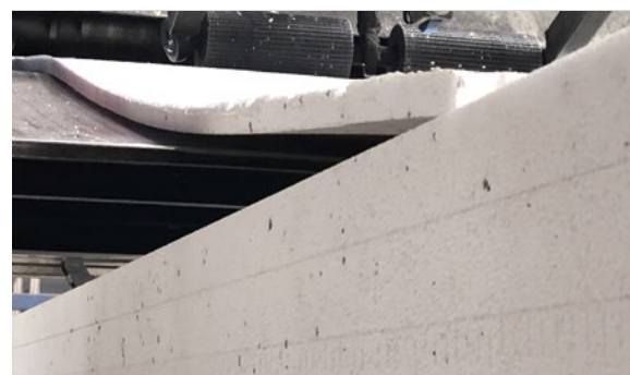
▶ Horizontaler Schnitt: Dicke der Platte wird geschnitten, äußere Platten mit Produktionshaut werden zur Wiederverwertung zerkleinert.
